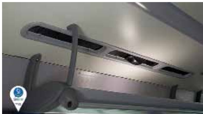
Iveco testet Eco 3 von Hispacold, ein Ionisiergerät, das in die Klimaanlage eingesetzt wird.
