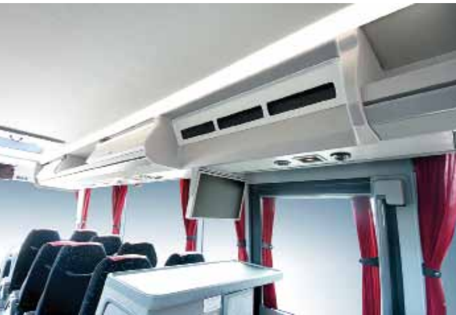
Mit dem CAPS-System filtert Van Hool in den Reisebussen der EX- und TX-Reihe die aus der Klimaanlage austretende Luft.
